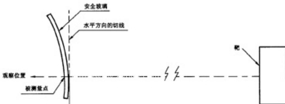
图 4 靶式光源仪观察示例
